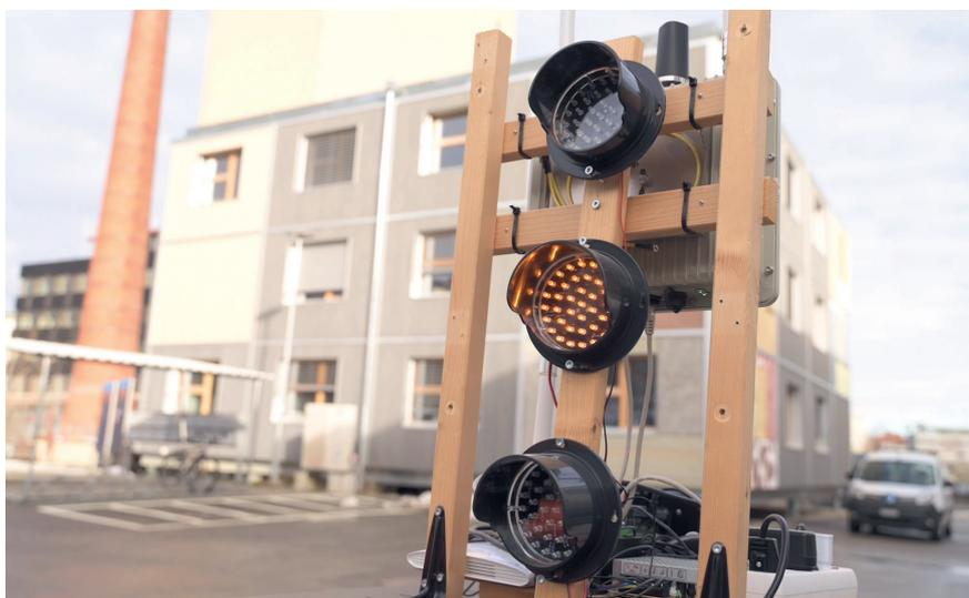
**Figure 2** Feu de signalisation équipé de la RSU (boîte grise derrière le feu).
