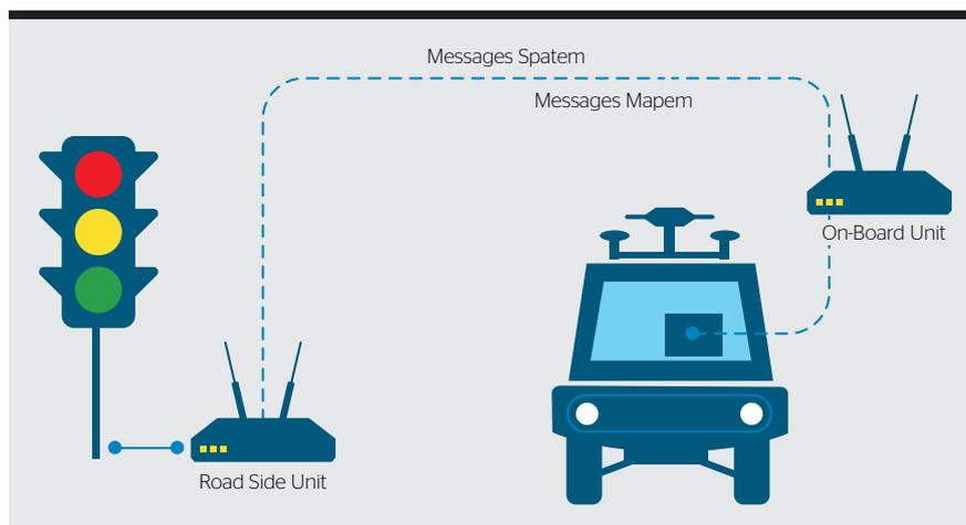
**Figure 1** L'écosystème ITS-G5: la RSU (Road Side Unit) reliée au feu de signalisation transmet des messages Spattem, relatifs à l'état du feu, et Mapem, relatifs à sa localisation, à l'OBU (On-Board Unit) embarquée dans le véhicule.
